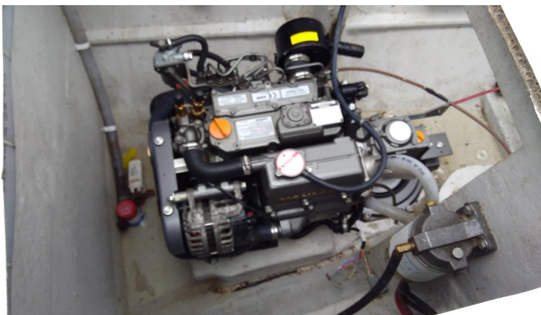
Acesso a banana de “Be” e visão de um dos motores Yanmar 29 HP
